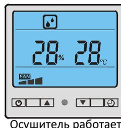
2). Кнопка “” . Нажмите ее для выбора необходимого вам режима. Осушитель имеет 4 режима работы: осушение “” , подача воздуха “” , обогрев “” , осушение и обогрев “” , (Функция обогрева доступна на моделях с электронагревателем)
